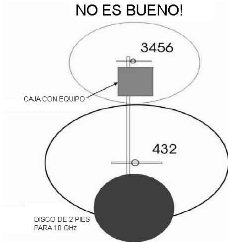
Figura 9 – La caja de equipo ocupa casi 1/8 de la apertura de la antena. .125 = .6 dB Por qué gastar todo ese tiempo y dinero para lograr unos pocos dB en 3456 MHz sólo para desperdiciarlos en una instalación pobremente diseñada?
